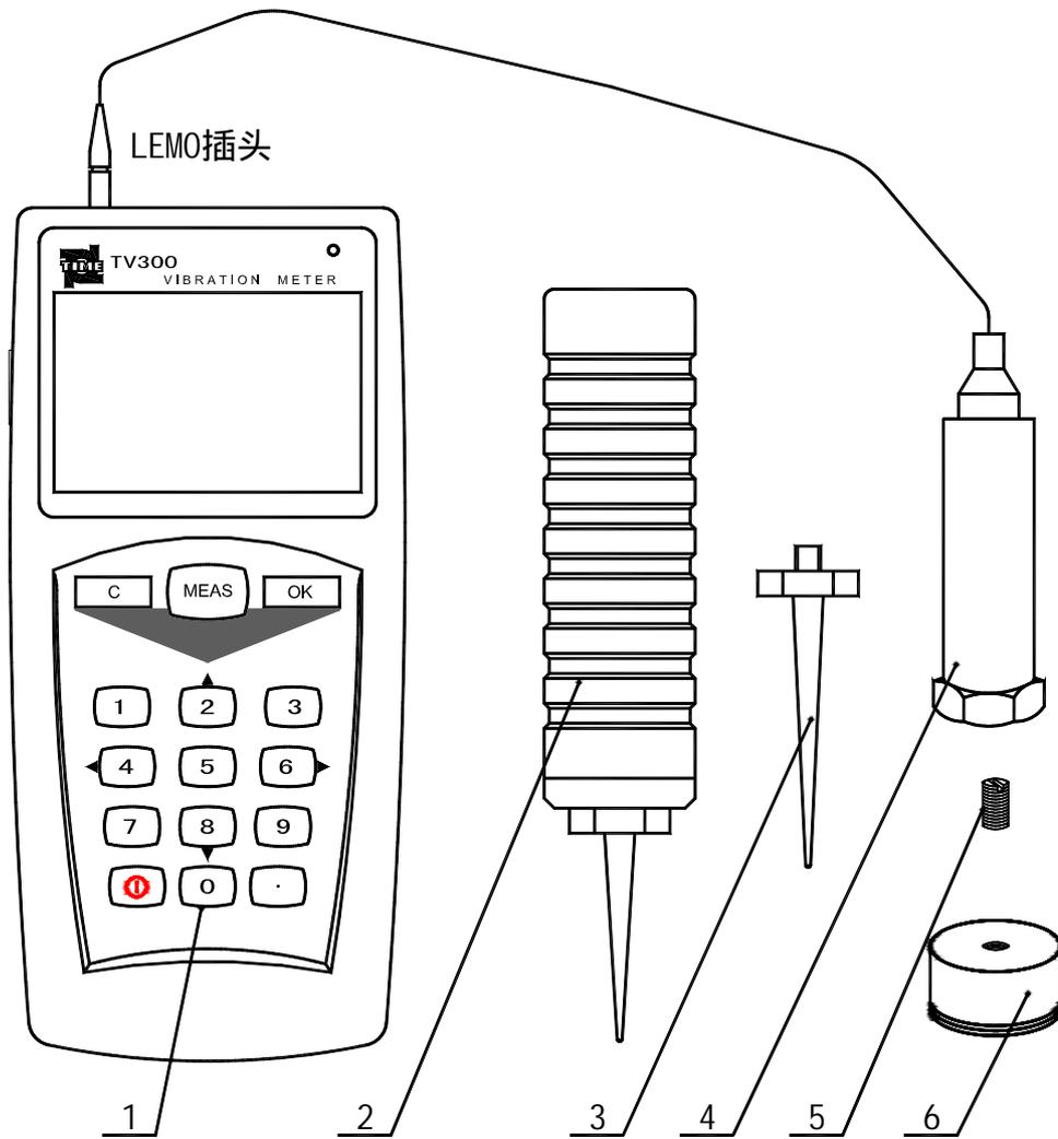
1. 主机 2. 触针组件 3. 长触针 4. 测振探头 5. 螺柱 6. 磁性吸座
