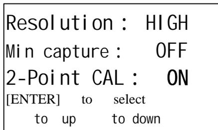
5) 按 **ENTER** 键循环显示 ON(打开二点校准)、OFF(关闭二点校准)。
