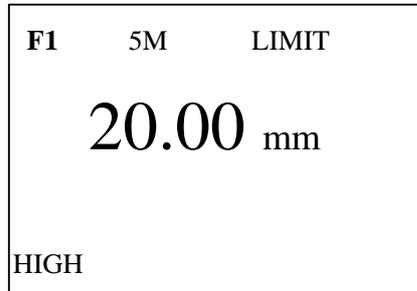
2) 按 ENTER 键, 文件号按 F1~F5 可循环显示, 按 VEL 键或进行一次测量可退出设置, 文件号设定好之后, 每次测量完可按 MEM 键将测量值存入文件, 存储完成后显示一次“Memory”进行提示。
