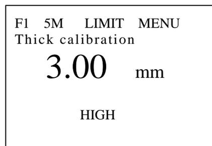
3) 测量厚的标准试块，用 $\wedge$ 或 $\vee$ 键将测量值调整到标准值，然后按 **ENTER** 键，完成校准操作，可进行测量
