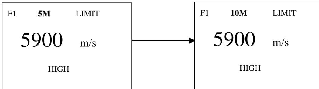
每按一次 ENTER 键将依次显示 2M(2MHz)、5M(5MHz)、10M(10MHz)、H2M ( 2MHz 高功率 ) 需要设定的探头频率。
