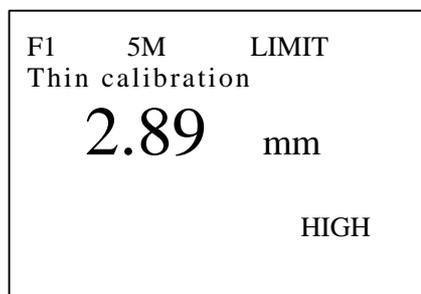
2) 测量薄的标准试块，用  $\wedge$  或  $\vee$  键将测量值调整到标准值，然后按 **ENTER** 键，屏幕提示校准厚块，显示如图:
